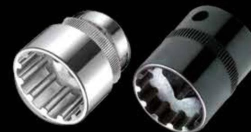
**Профиль TWINDRIVE** – улучшенный шестигранный профиль, предназначенный для работы с крепежом метрических и дюймовых систем, а также позволяет работать с крепежом метрической системы, изношенным до 50%.
